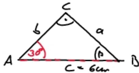
$$\beta = (180^\circ - 90^\circ - 30^\circ) = 60^\circ$$
